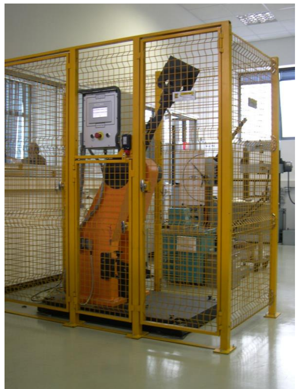
Pendolo PM 001/A con gabbia di protezione in rete metallica elettrosaldata
